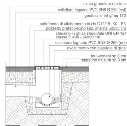
Dettaglio pozzetto acque scure - scala 1:20
