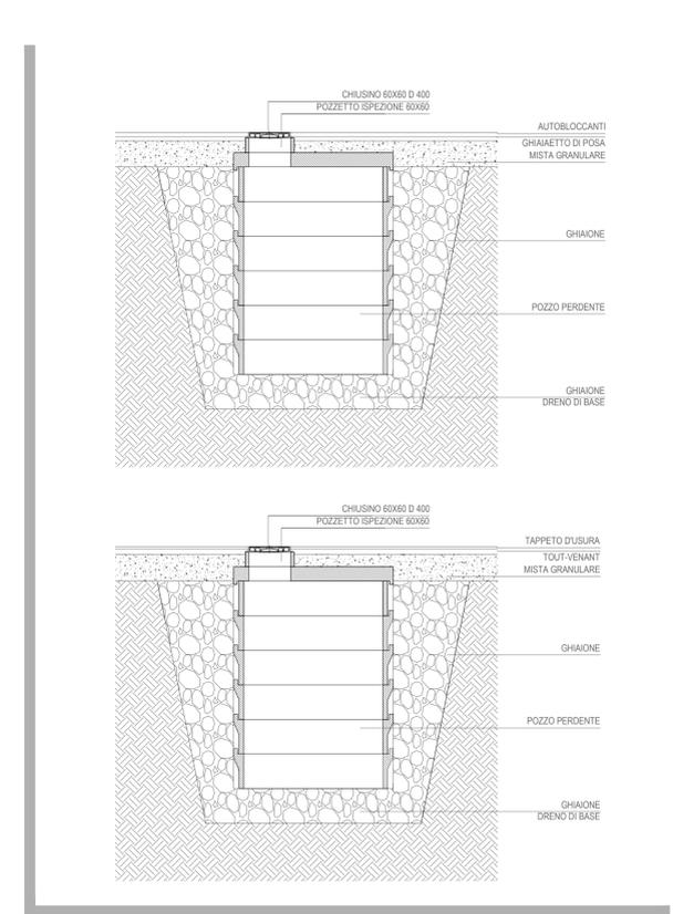
Dettaglio trincee drenanti - scala 1:50
